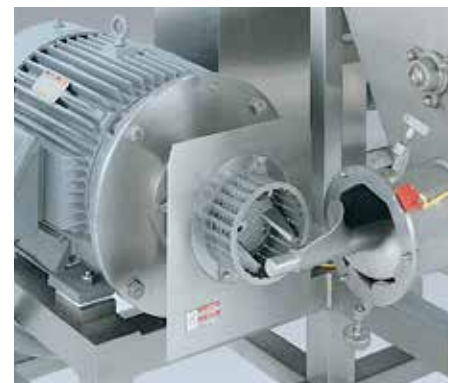
拆下外壳后的切割刀具 (如图所示)
