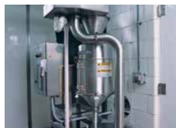
采用装有粗切刀头的1700型设备切割家禽的表皮。
